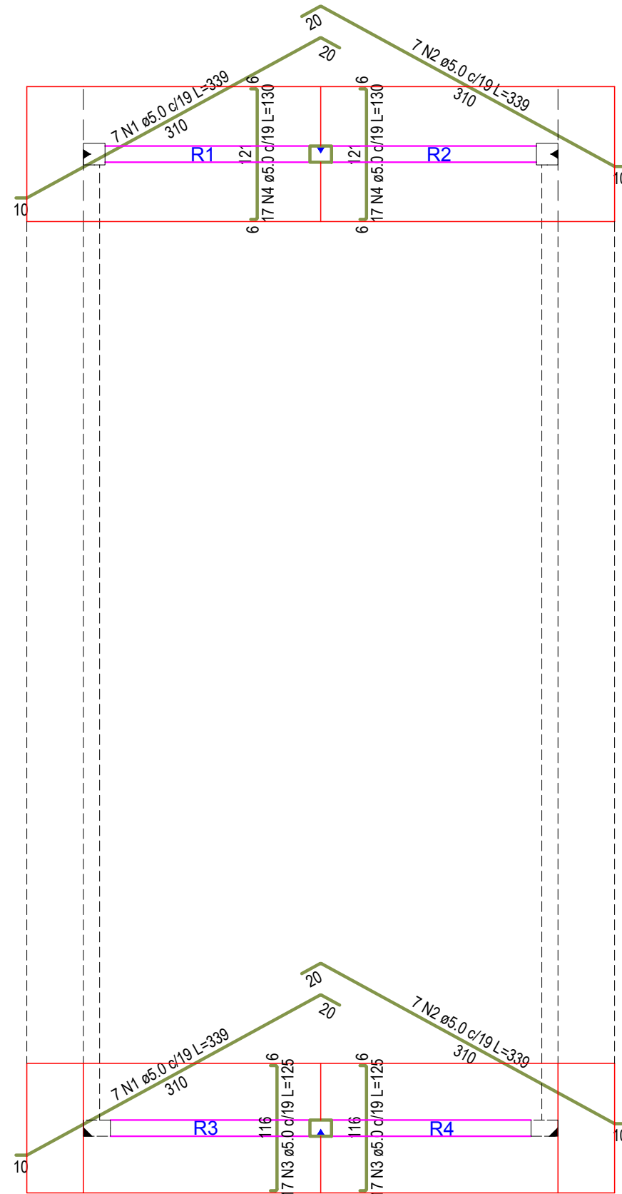
Armação positiva das lajes do Telhado escala 1:50
