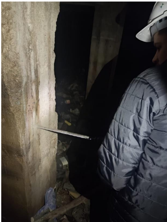
Figura 16 - Perfuração do pilar P25 para teste de carbonatação.
