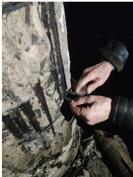
Figura 28 – Medição da armadura do pilar P24 com paquímetro
