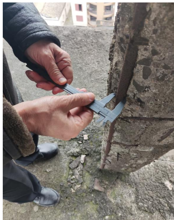
Foto 04 – P25. Avaliação da armadura.
