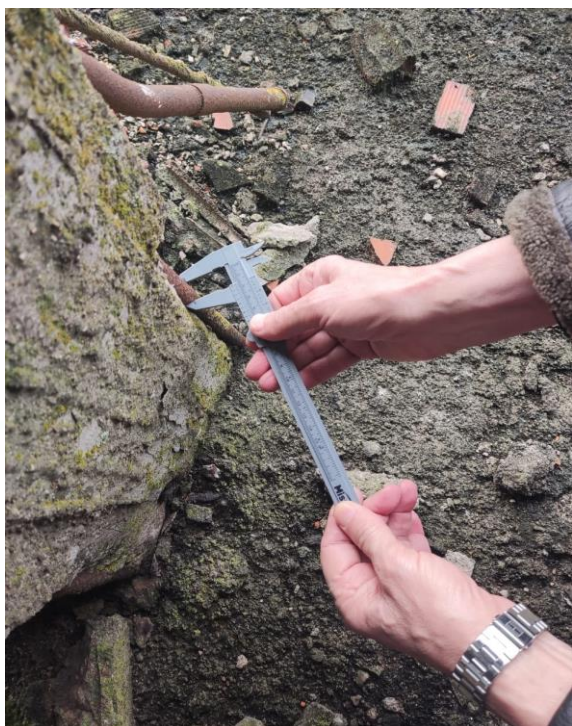
Foto 03 – P31. Avaliação da armadura.
