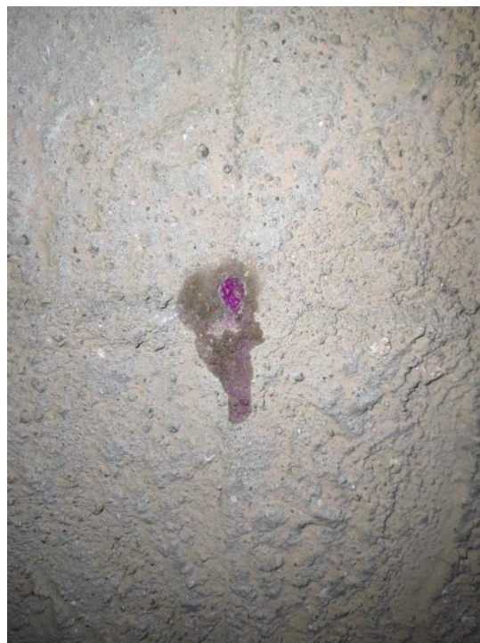
Figura 25 - Reação da fenolftaleína indicando bom estado de conservação do concreto e proteção da armadura do P37 (5º Pav. Tipo).
