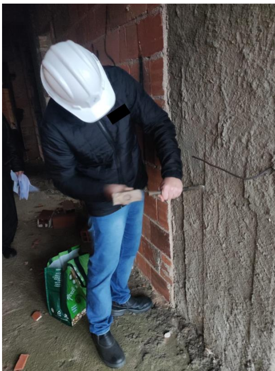
Figura 23 - Escarificação do pilar P37 (5º Pav. Tipo) para teste de carbonatação.
