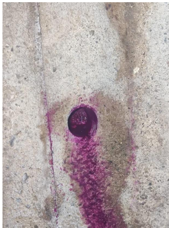
Figura 18 - Reação da fenolftaleína indicando bom estado de conservação do concreto e proteção da armadura do P25.
