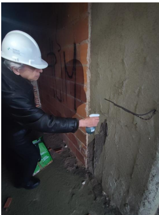
Figura 24 - Aplicação da fenolftaleína na abertura do pilar P37 (5º Pav. Tipo).
