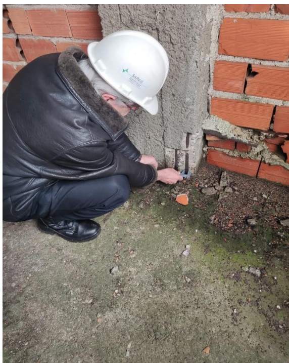
Foto 03 – P31. Avaliação da armadura.
