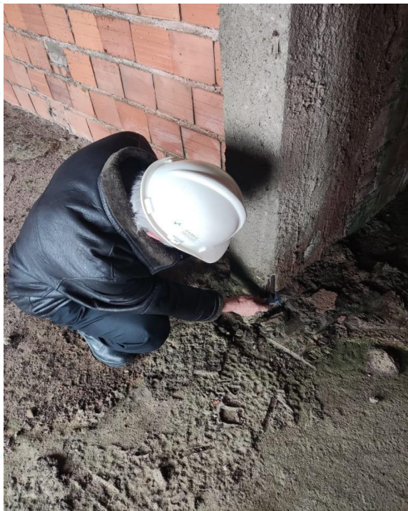
Foto 05 – P20. Avaliação da armadura.
