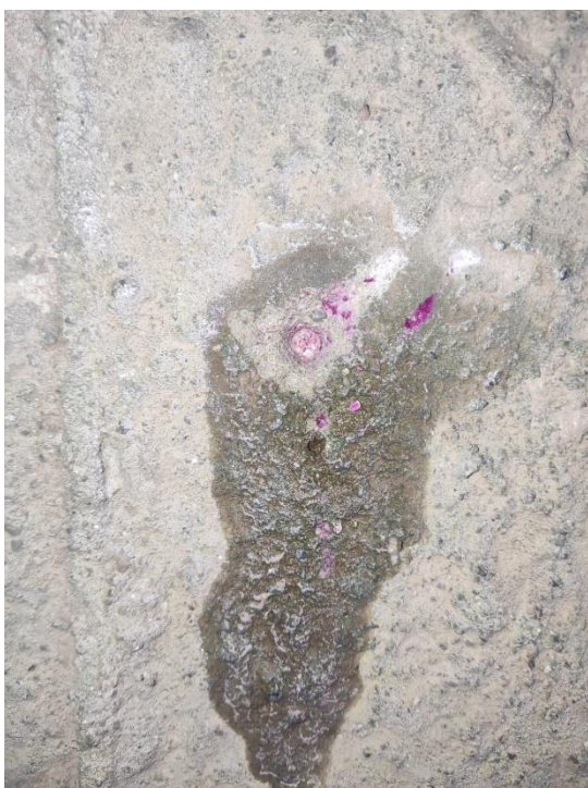
Figura 21 - Reação da fenolftaleína indicando bom estado de conservação do concreto e proteção da armadura do P37 (8º Pav. Tipo).
