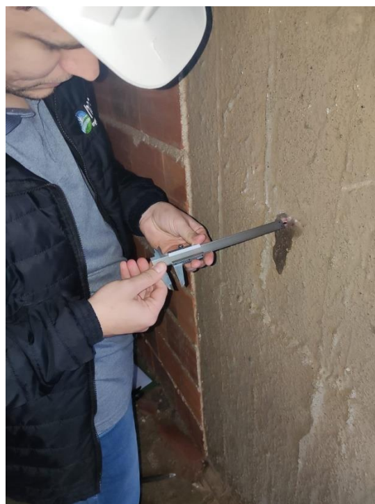
Figura 22 - Medição com paquímetro da profundidade de carbonatação no P37 (8º Pav. Tipo).
