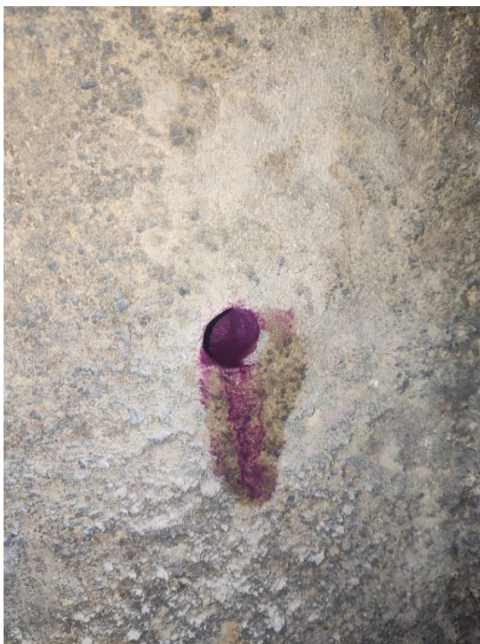
Figura 15 – Reação da fenolftaleína indicando bom estado de conservação do concreto e proteção da armadura do P46.
