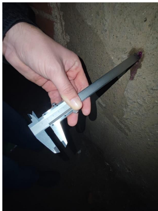
Figura 26 - Medição com paquímetro da profundidade de carbonatação no P37 (5º Pav. Tipo).
