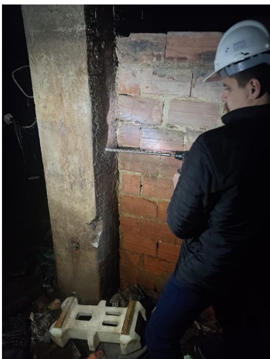
Figura 13 – Perfuração do P46 para teste de carbonatação.
