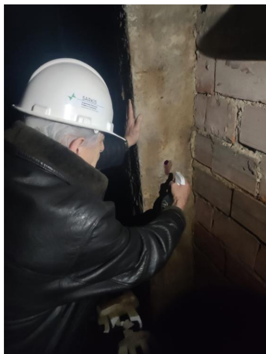
Figura 14 – Aplicação da fenolftaleína na abertura do pilar P46.
