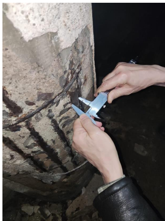
Figura 30 – Medição da armadura do pilar P25 com paquímetro
