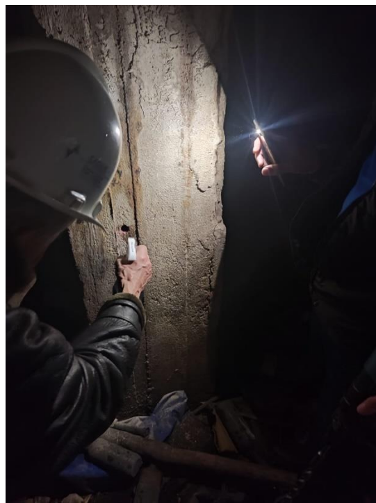
Figura 17 - Aplicação da fenolftaleína na abertura do pilar P25.
