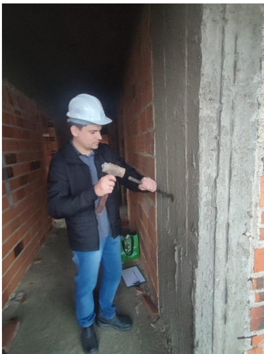
Figura 19 - Escarificação do pilar P37 (8º Pav. Tipo) para teste de carbonatação.
