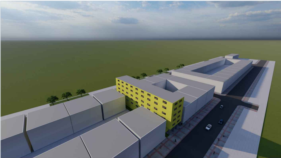
Solução demolindo o existente e construindo nova edificação dentro dos índices atuais, com afastamento de 2,57 m e h=19m = 6 pavimentos
