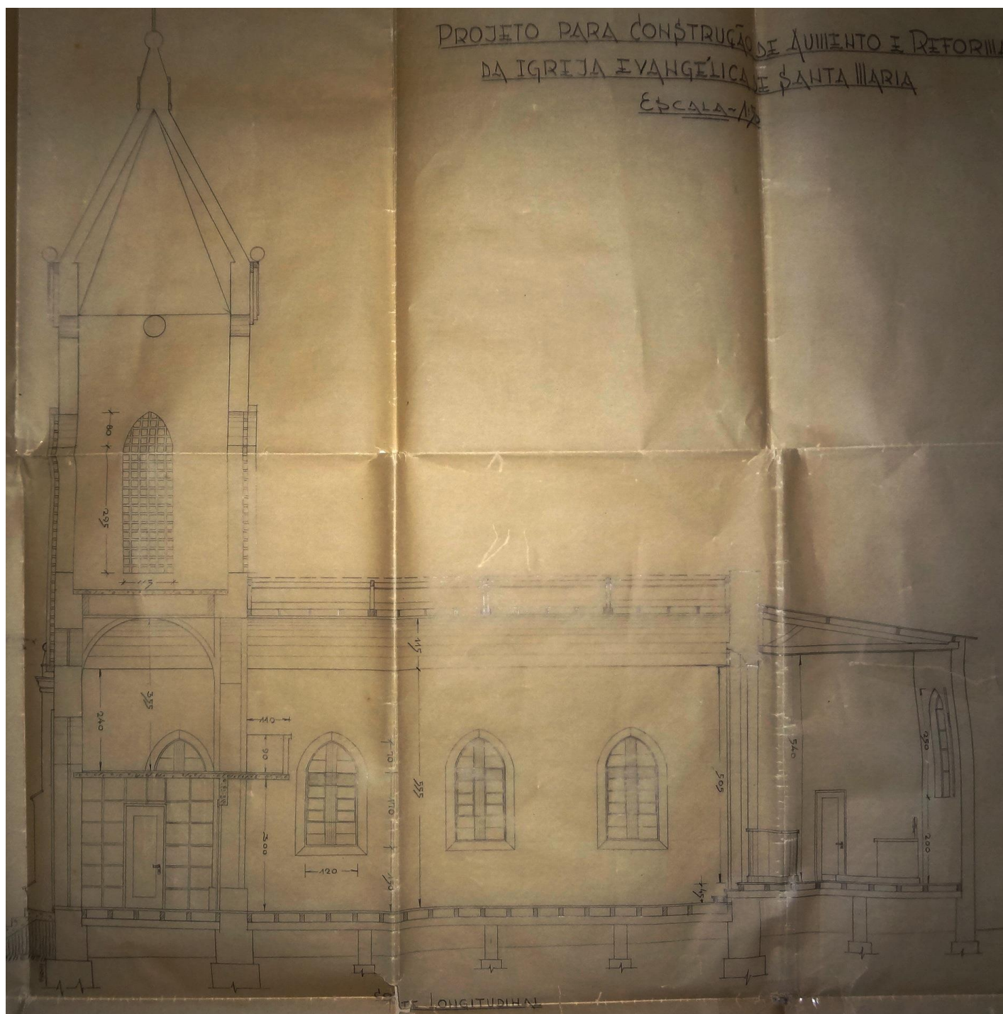
Figura 18: Corte longitudinal para aumento e reforma do Templo, projeto do ano de 1959, desenho feito a mão em papel manteiga. Fonte: Arquivos da Comunidade Evangélica Luterana de Santa Maria, 2012.
