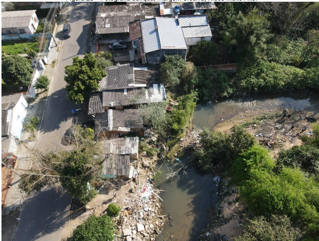
Figura 28 – Fotografia oblíqua, margem erosiva, Risco Muito Alto.
