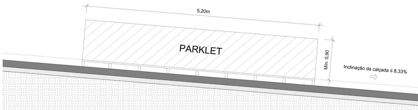
b) Parklet instalado em via com inclinação longitudinal maior que 8,33%.
